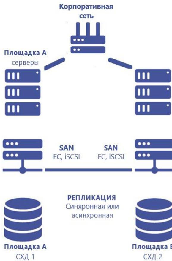
Для репликации доступны следующие топологии: 1:1, 1:n, n:1, n:m. Хосты могут подключаться к СХД по FC и iSCSI. Каждый хост подключается только к локальной СХД.
