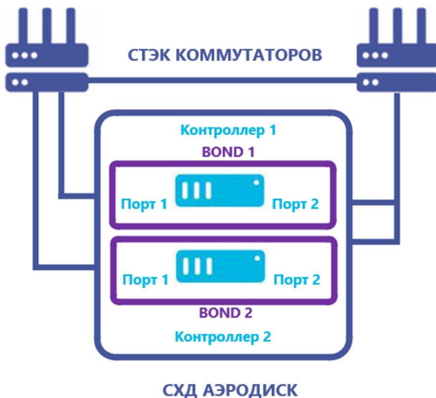
«ПОРТ 1» и «ПОРТ 2» объединены в BOND 2x10 Гбит/с LACP на контроллерах 1 и 2. VLAN – 10, 100, 1000 доступны на BOND интерфейсах.
