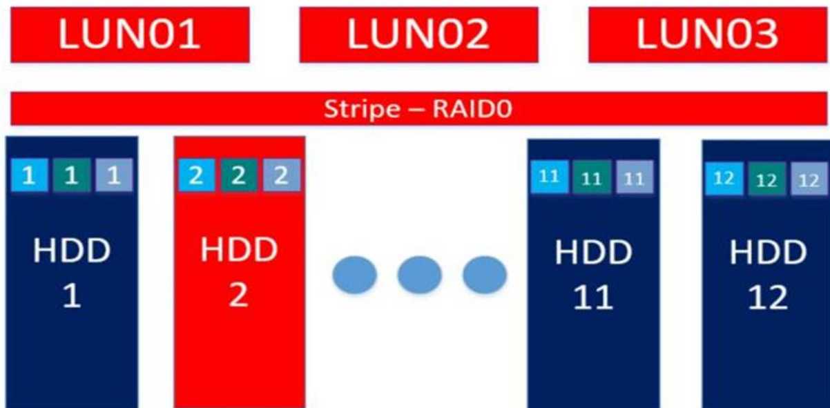
Рисунок 14. Организация RAID-0 на группе DDP с вышедшим из строя диском
